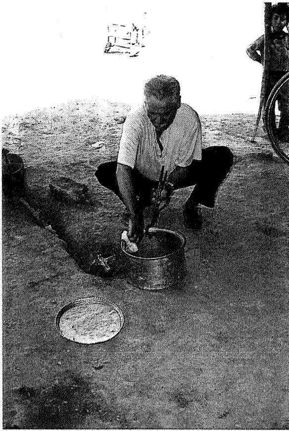
Photo 35: Der Kesselreiniger (Mubayyid) bei der Arbeit. Der in den Boden eingelassene Brenner und die Greifzange sind unerläßliche Arbeitsinstrumente.
