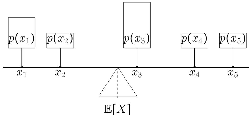
Auf einer Balkenwaage (deren Balken Eigengewicht 0 habe) liege an der Position  $x_i$  das Gewicht  $p(x_i)$ . Damit der Balken in Ruhelage ist, muss man ihn an der Stelle  $\sum_{i=1}^n x_i p(x_i) = \mathbb{E}[X]$  unterstützen, denn dann ist das Gesamtdrehmoment (proportional zu)
