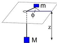
Eine Masse  $m$  rotiere auf einer ebenen Tischplatte. Über einen Faden der Länge  $l$  sei sie durch ein Loch in der Platte mit einer anderen Masse  $M$  verbunden. Wie bewegt sich  $M$  unter dem Einfluß der Schwerkraft?
