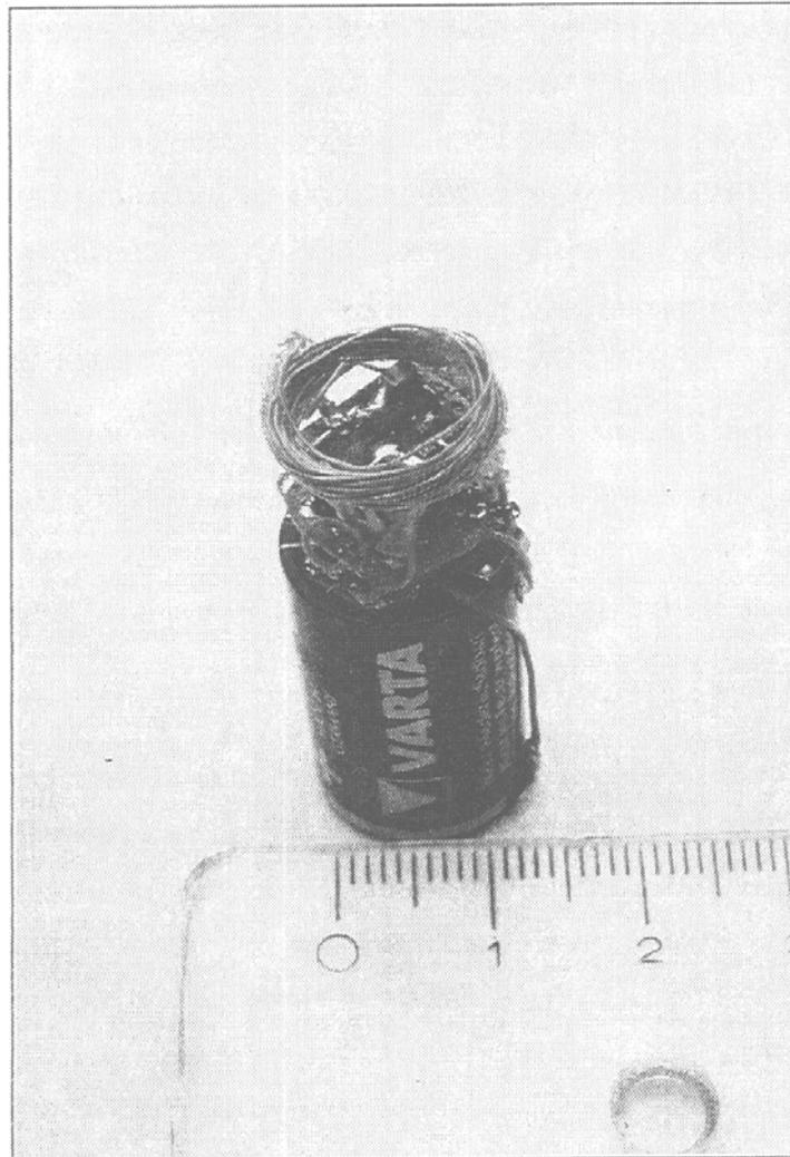
**Abbildung 9: Implantierbarer Telemetriesender aus den Freigehegestudien**
